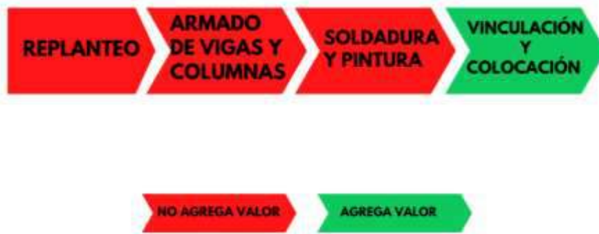
Figura 5. Proceso armado de estructura metálica
