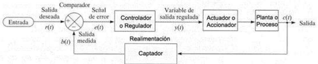
En él, la salida es realimentada hacia la entrada; ambas se comparan, y la diferencia que existe entre la entrada, que es la señal de referencia o consigna (señal de mando), y el valor de la salida (señal realimentada) es la señal de error.
