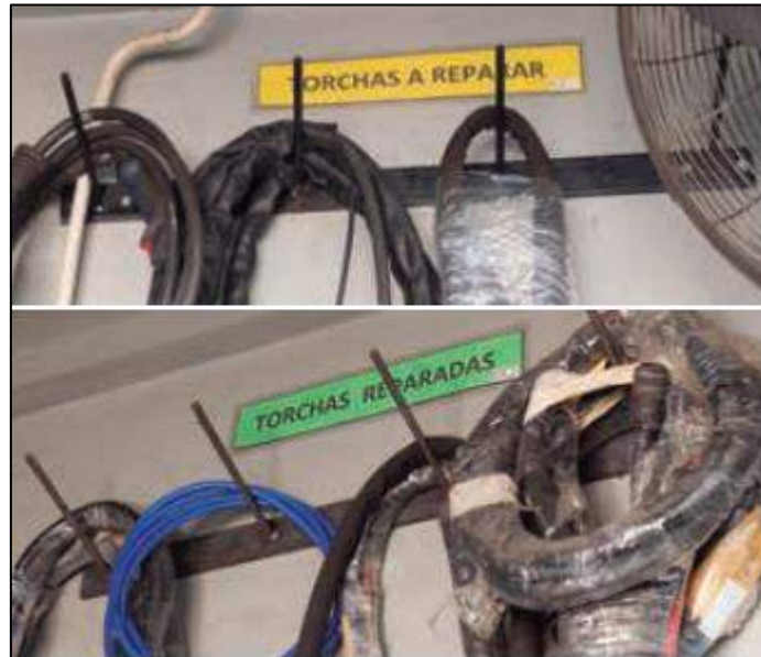
Figura n° 9: Ejemplo de identificación de productos con defectos
