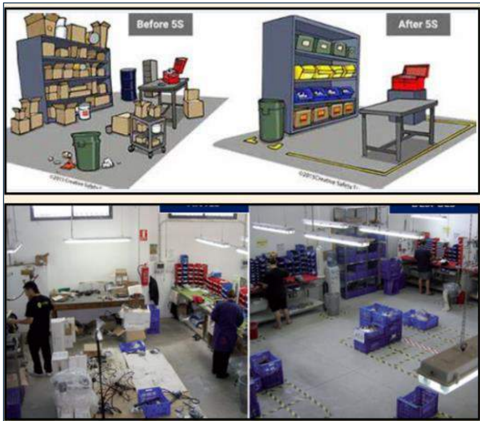
Figura n°52 : Ejemplos de antes y después de la aplicación de las primeras dos “S”
